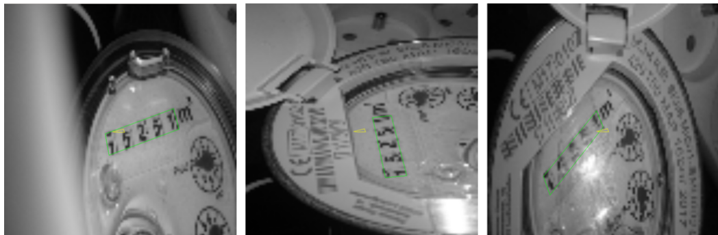
Obr. 5.3: Ukážka výsledkov predikcie súradníc rohov ciferníka pomocou viacvrstvej doprednej neurónovej siete. Zelené orámovanie na obrázkoch predstavuje skutočnú anotáciu obrázkov a žlté orámovanie je výsledok predikcie siete.
