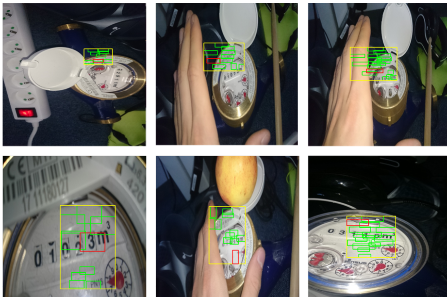
Obr. 5.5: Ukážka výsledkov metódy detekcie textu na obraze. Zelené orámovania predstavujú detegovaný text pomocou modelu EAST. Červené orámovanie je najväčšie detegované textové pole (druhá heuristika) a žlté orámovanie je najmenšie pokrytie detegovaných prámovaní (prvá heuristika).
