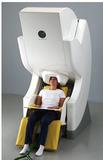
Obr. 1.1: SQUID prístroj na meranie MEG signálov.
