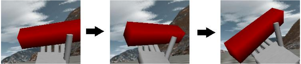
Obr. 4.4: Postupné aktívne natočenie kĺbov ruky. Na prvom obrázku je počiatočný stav, na druhom po prvom natočení a na treťom je po druhom natočení kĺbov. Táto poloha sa už ďalej nemenila.
