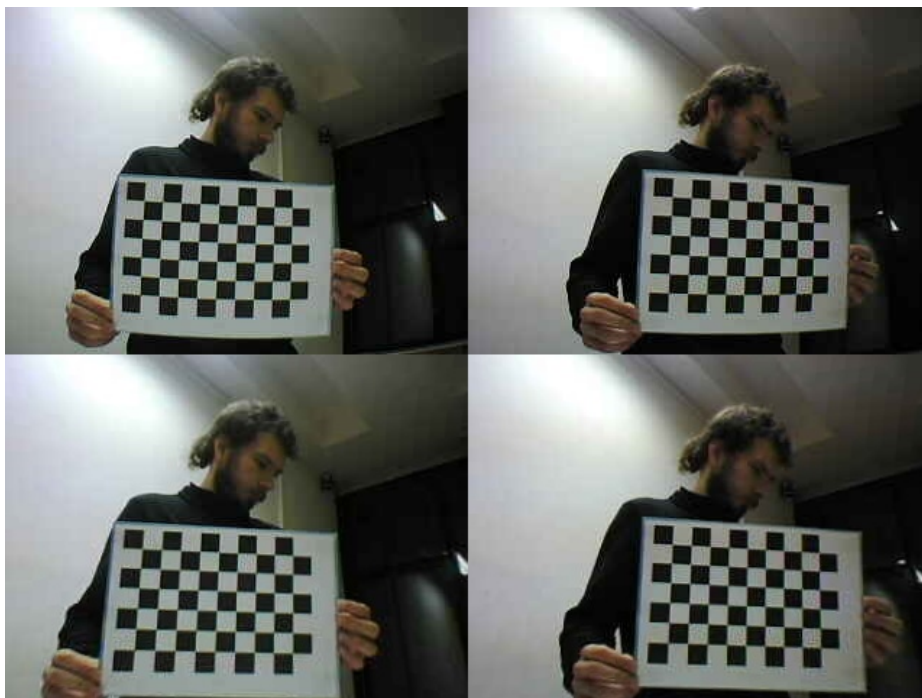
Obrázok 2.7: Ukážka odstránenia skreslenia podľa parametrov vypočítaných funkciou calibrateCamera . Vo vrchnom rade sú stereo obrázky pred kalibráciou a v spodnom rade sú obrázky po kalibrácii.
