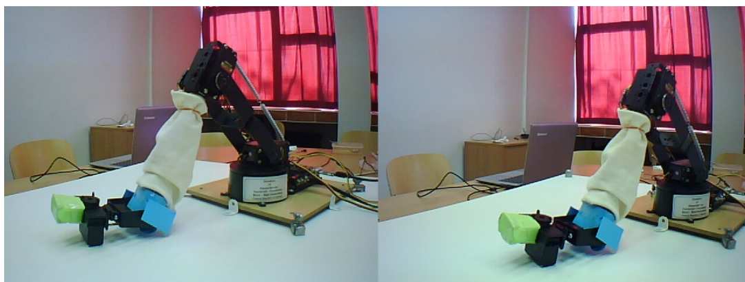
Obrázok 4.3: Obrázok robotického ramena, tak ako bol zosnímaný pri zbere reálnych dát - ešte z neho nie je odstránené skreslenie šošoviek. Pôvodný obrázok má rozlíšenie 640x480 pixlov.
