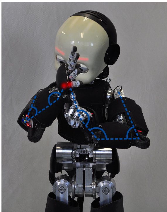
Obr. 2: Robot iCub v konfiguraci sebe-doteku. Jeho kinematická struktura (délky jednotlivých segmentů a úhly mezi nimi) je zjednodušeně znázorněna modře. Červená ohniska odpovídají taktilním stimulacím na levé a pravé ruce.
