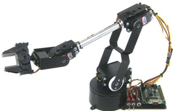
Obr. 1: Robotické rameno Lynxmotion AL5D s rozhraním SSC-32U.
