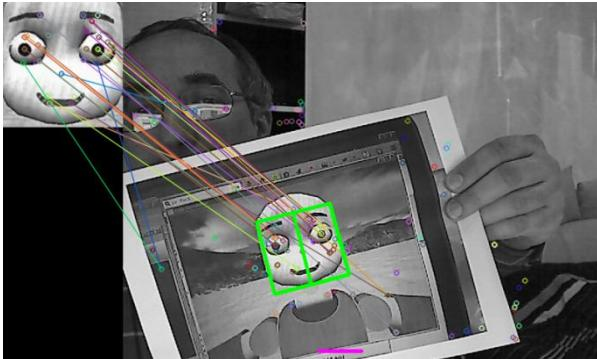
Obr. 8: Získanie modelu z obrazu robota (SURF)
