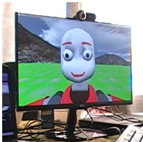
Obr. 4: Simulátor iCubSim rozšírený o kameru
