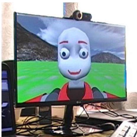
Obr. 4: Simulátor iCubSim rozšírený o kameru
