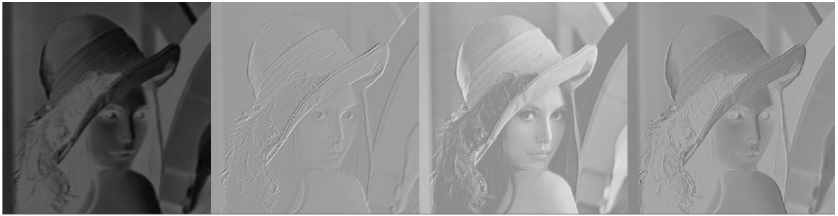
Obrázok 10: Obráz po štvornásobnej aplikácii operácie priestorovej konvolúcie
